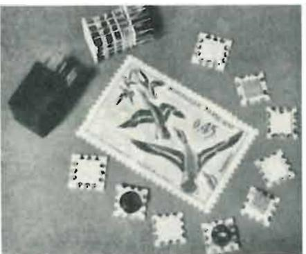
Fig. 3 - In figura sono rappresentate le piastrine sciolte, collegate assieme tramite conduttori passanti per gli incavi e in fine racchiuse in scatola, di un micromodulo C.F.S.; i componenti sono: transistor, bobina, condensatori multistrato al tantalio e resistenza.
